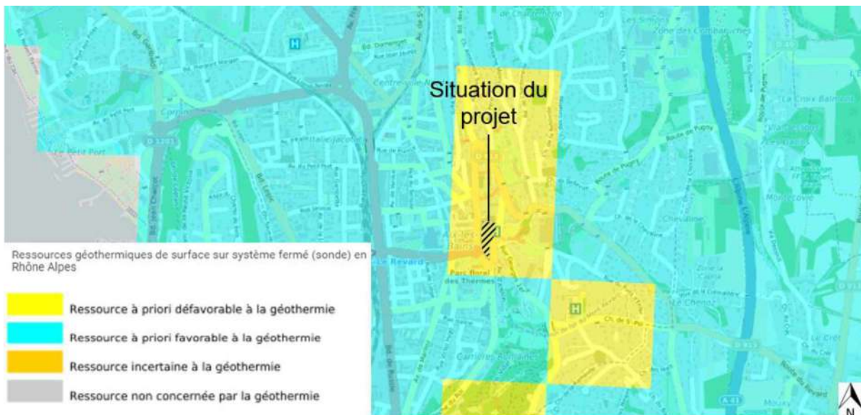
Extrait de la carte des potentiels de géothermie sur sonde verticale en région Auvergne-Rhône-Alpes, BRGM, consultée en novembre 2021.
