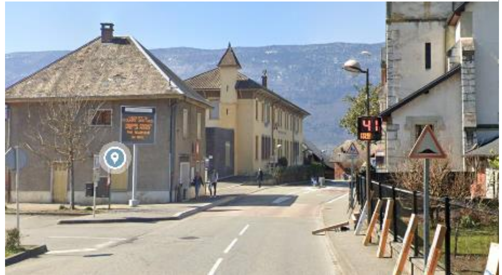
Voirie limitée à 30 km/h dans le centre-ville de Viviers-du-Lac avec ralentisseur puis radar pédagogique
